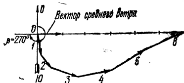
Рис. 1.7. Графический метод определения направления и скорости среднего ветра
